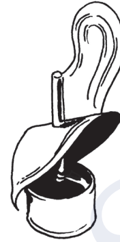
Kääntyvä tuuliohjain ohjaa poistoilmavirran tuulen alapuolelle.
